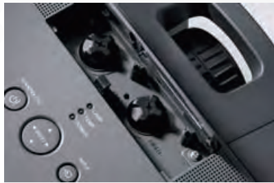
▲ LX400具有手动变焦和聚焦、水平和垂直镜头移动, 可选用多种镜头。
