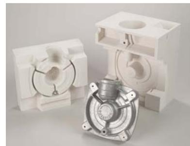
ZCast 三维打印成型模型和铝铸部件
